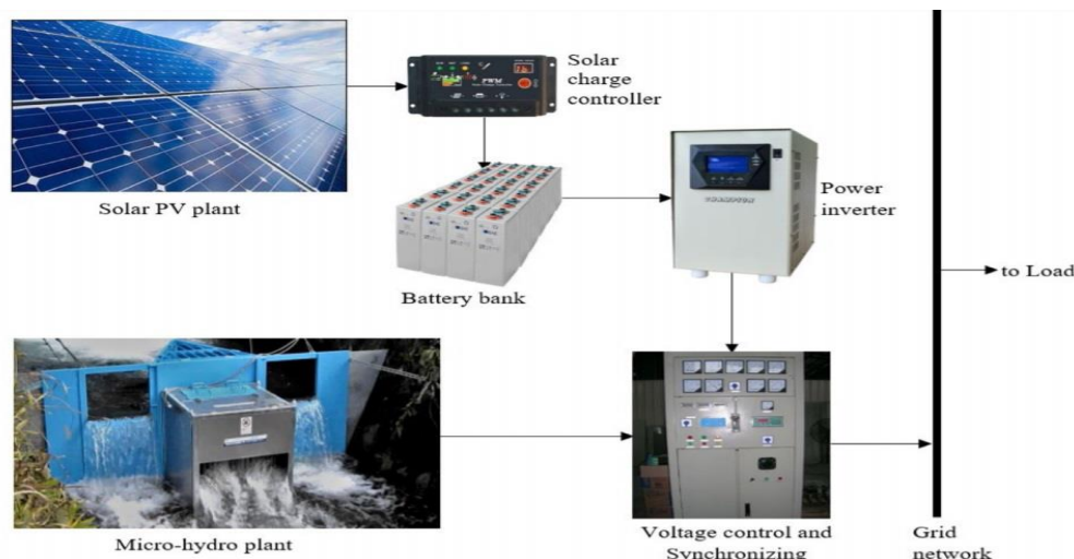
شکل ۶) نمای کلی مولفه های اصلی یک سیستم خورشیدی-آبی تولیدکننده برق [۱۷]
